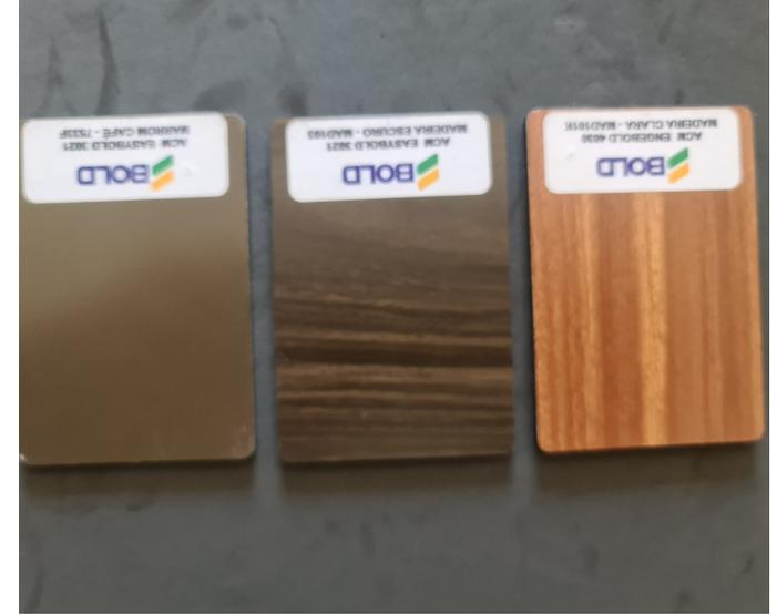
**O Painel de Alumínio Composto é constituído por duas lâminas de alumínio e um núcleo de polietileno de baixa densidade, laminados através de um processo de colagem sofisticado que envolve adesivos químicos a temperaturas elevadas.**
